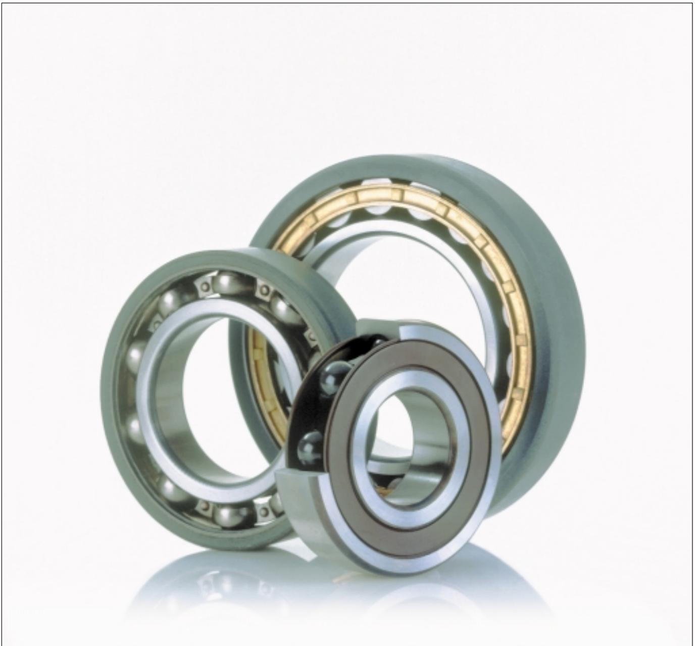
An den Lagern von Elektromotoren können unter ungünstigen Bedingungen Stromdurchgangsschäden auftreten. Magnetische Unsymmetrien, die auch bei sorgfältiger Fertigung der Motoren nicht ganz vermieden werden können, rufen ein Spannungsgefälle zwischen Rotor und Stator hervor. Der Stromkreis schließt sich über die Lager. Besonders gefährdet sind Wälzlager in Elektromotoren, die mit einer Umrichtereinspeisung betrieben werden.
